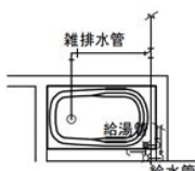
【浴室廻り給排水】
